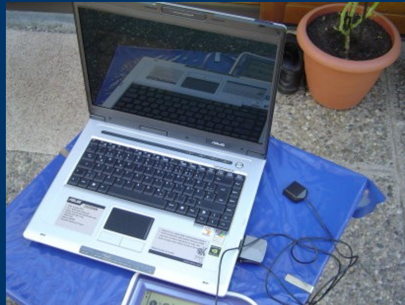
Nicht unbedingt handlich bei outdoor-Nutzung, sonst aber vielseitig: Notebook mit GPS-Adapter im PCMCIA-Slot und mit Außenantenne
